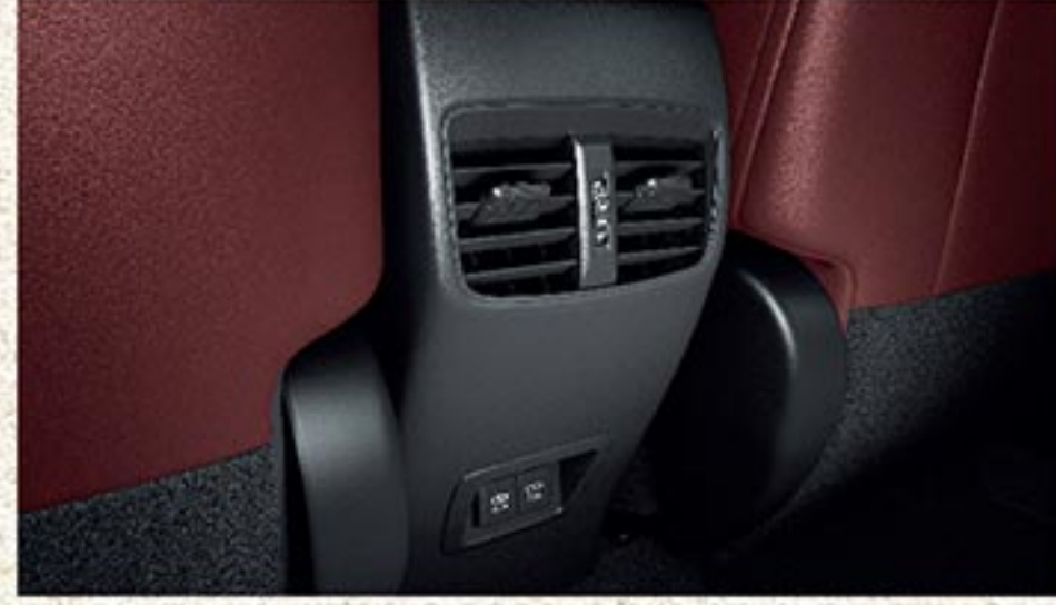
ช่องแอร์และช่องต่อ USB สำหรับผู้โดยสารด้านหลัง
